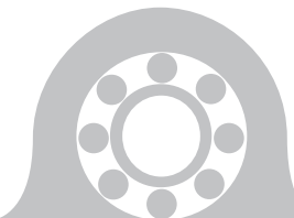
UKP208JP11 スキマはアダプタースリーブによって調整 カタログ推奨締め付けトルクの 1.5 倍を目安
