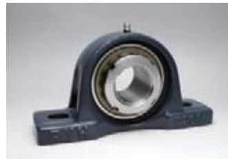
UKP208JP11 スキマはアダプタースリーブによって調整 カタログ推奨締め付けトルクの 1.5 倍を目安
